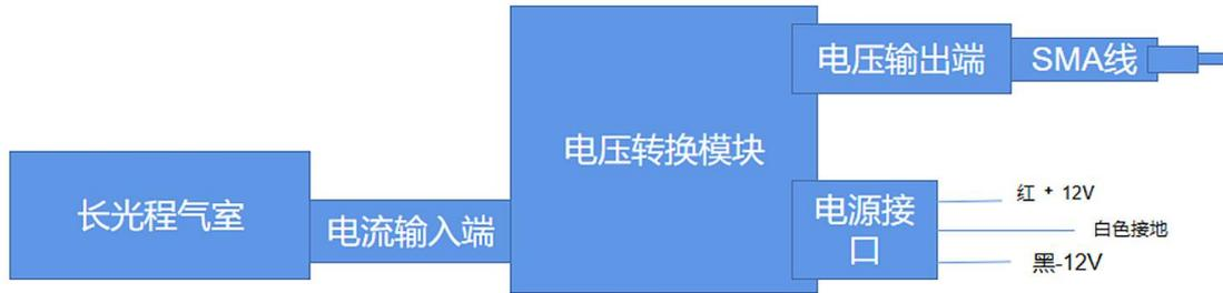
电压转换模块需同时加载上 $\pm 12V$  直流电压后方可工作。
