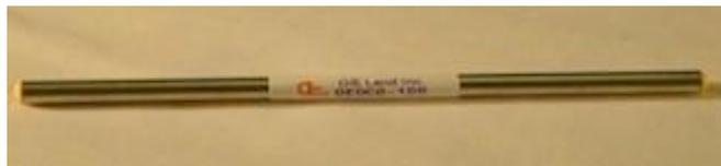
图 2：采用非热封装的色散补偿光纤光栅
