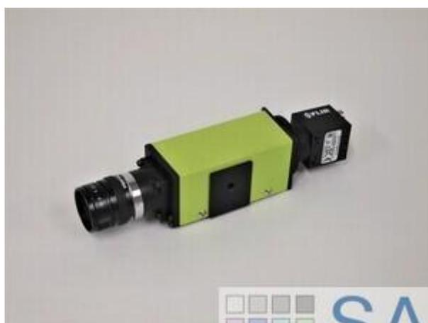
镜头和相机安装示例（高光谱相机）
