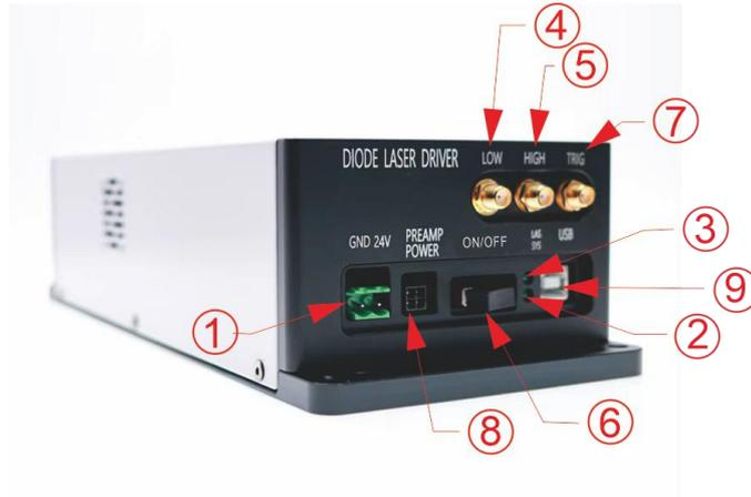
1 电源输入；2 电源指示；3 工作指示；4 低频输入；5 高频输入；6 手动按钮；7 触发按钮；8 放大器电源；9 USB 接口
