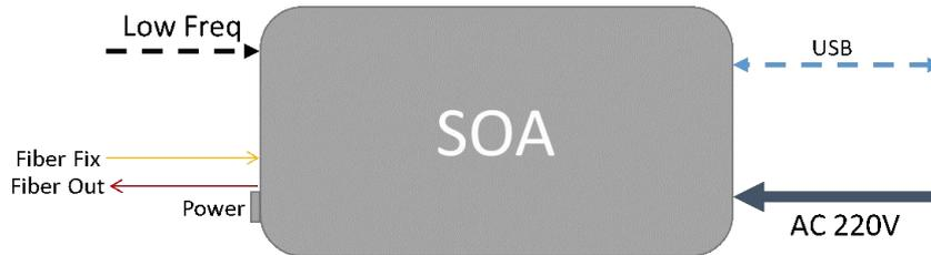
Low Freq: SOA 外部电流调制输入端，支持 0~40MHz 的频率信号，Min. 信号脉宽 10 ns。
